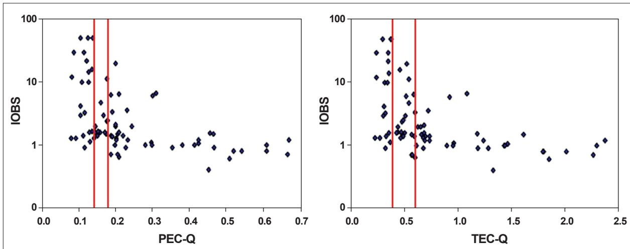
Fig. 1. Relation entre l'indice IOBS et l'indice de contamination PEC-Q (gauche) et TEC-Q (droite). Les seuils de toxicité 1 et 2 sont indiqués en rouge (d'après Vivien et al. 2014).
